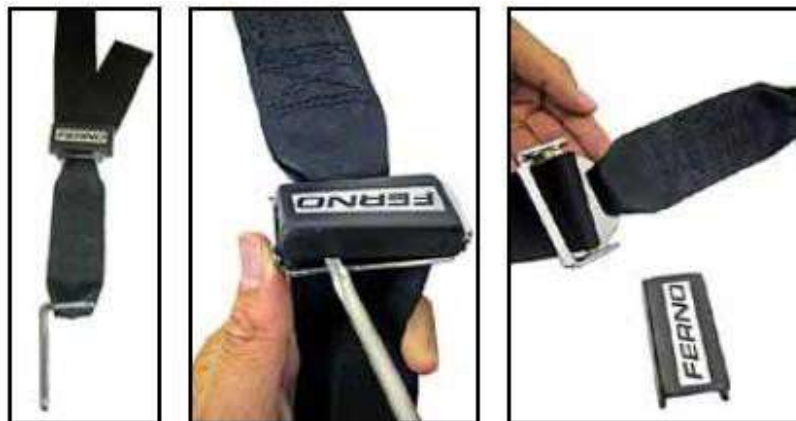
Odstránenie plastového krytu
